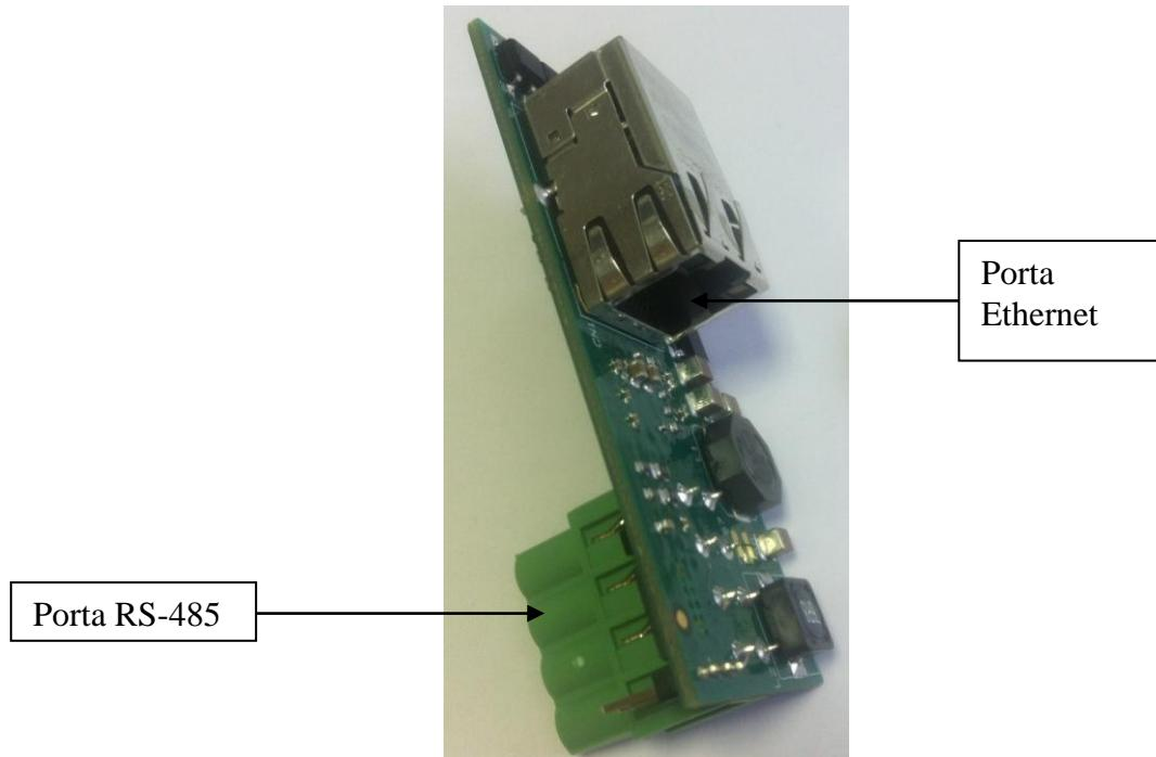
Nel caso di installazioni preesistenti di barriere, con alimentazione già presente nella barriera stessa, per effettuare il collegamento verso la rete Ethernet occorre utilizzare IP-DOORWAY-C avendo cura di aprire i ponticelli S1, S2, S4, S5.
