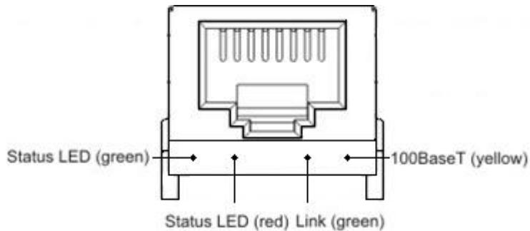
Il led giallo **100BaseT** si accende se la rete supporta la trasmissione dati a 100Mb/s. Installare e collegare alla rete tutti gli adattatori IP-DOORWAY che compongono l'impianto.
