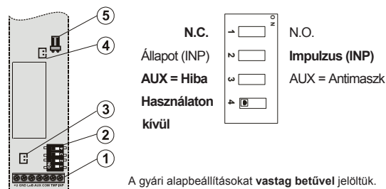
3. ábra - adóegység: 1 – sorcsatlakozók, 2 – DIP kapcsolósor (gyárilag beállítva), 3 – külső szabotázscsatlakozó, 4 – külső antenna csatlakozó jumper, 5 – külső antenna csatlakozó
